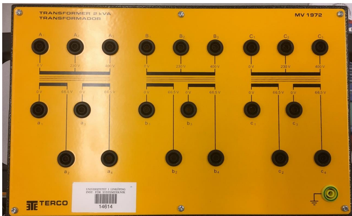
Figur 9 3-fas laborationstransformator som ska mätas upp med omsättningsprov, kortslutningsprov och tomgångsprov.
