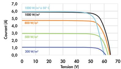
Caractéristiques courant/tension en fonction de l'ensoleillement et de la température du module.
