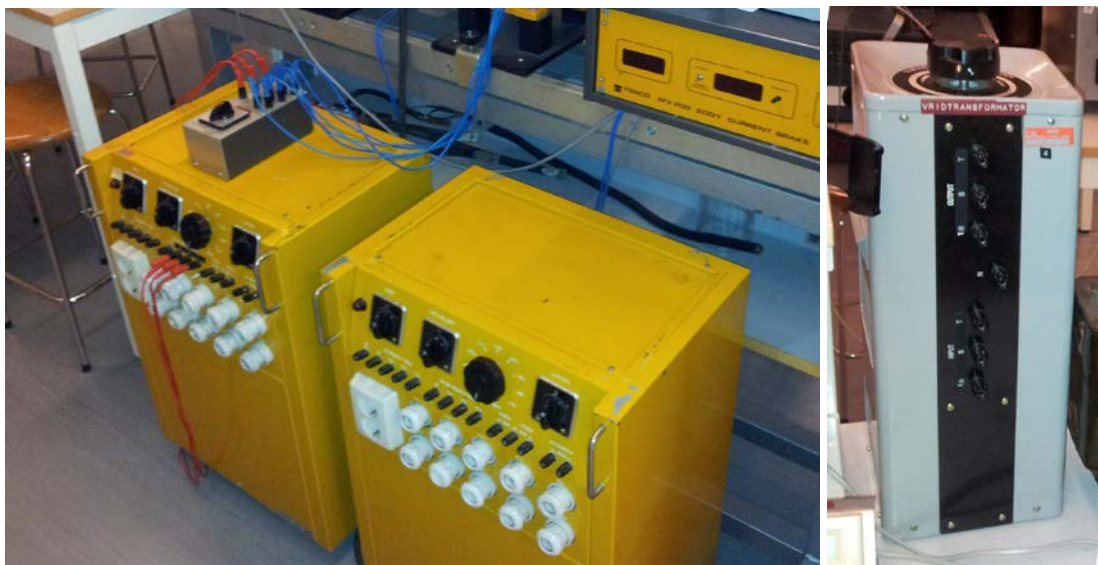
Figur 7 Terco transformator (vänster) och alternativ vridtransformator (höger)
