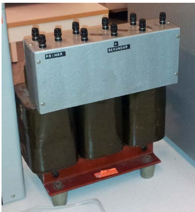
Figur 11 3-fas laborationstransformator som ska mätas upp med omsättningsprov, kortslutningsprov och tomgångsprov.
