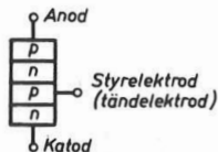
Schematisk uppbyggnad av thyristor med skikt av p- och n-typ
