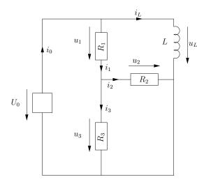
$$x_1 = i_L, x_2 = (i_3, u_2, i_2, u_0, u_1, u_L, i_1, i_C, i_0)$$
