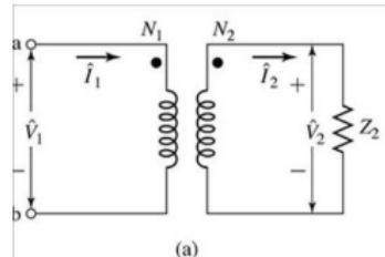
**Lösning:** Beräkna ekvivalent impedans
