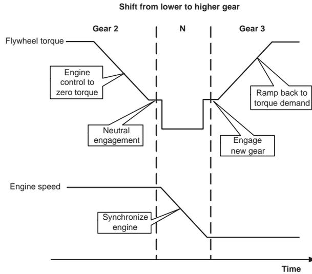
**Figure 1.1.** Gear shift principle.
