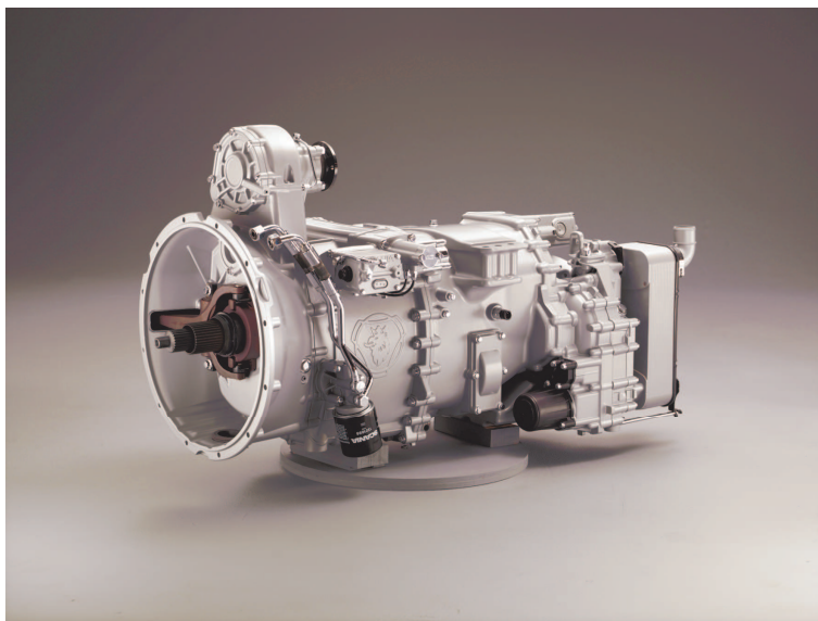
Figur 9.1. I modellen används utväxlingskaraktäristiken från växellådan GRSO905, foto: Stefan Almers
