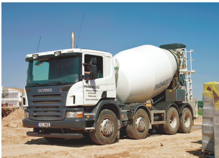
Figur 3.9. Cementmixer för transport av cement och betong, foto: Jonas Nordin
