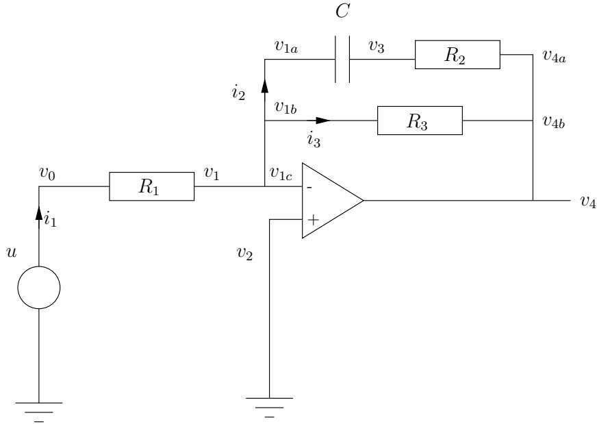
med komponenterna  $R_1, R_2, R_3, C, \text{Amp}, \text{Gen}$  som alla kan gå sönder. En ideal modell av kretsen, med endast beskrivningar av nominellt beteende, kan skrivas med följande linjära ekvationer:
