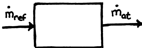
Figur 2.3: Blockschema över gasspjället.
